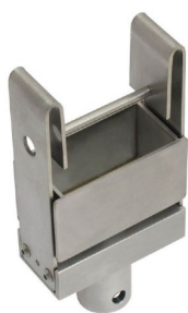
"FINCH" WET TENSILE TEST TAPPI T 456 om-03
