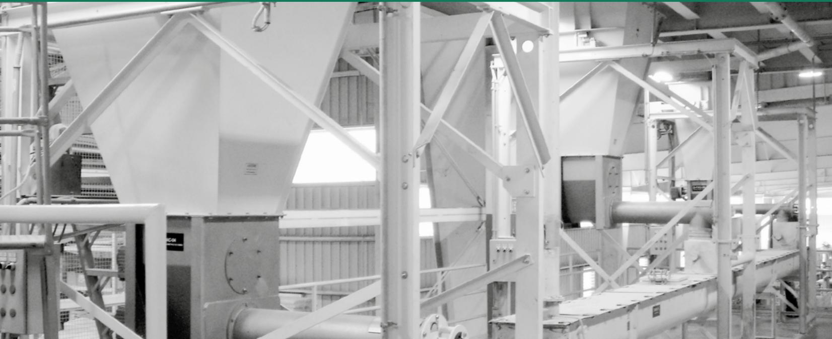
Abhängig vom Sollwert und der Gewichtsabnahme im Wiegebehälter wird die Schneckendrehzahl geregelt, sodass die Dosierleistung genau dem vorgegebenen Sollwert entspricht. Um die notwendige Stabilität für eine hochgenaue Messung gewährleisten zu können, sind KUKLA-Differential-Dosierwaagen auf einem massiven Stahlrahmen aufgebaut, die Differential-Dosierwaagen können auf Anfrage für ATEX und in druckstoßfester Ausführung geliefert werden.
